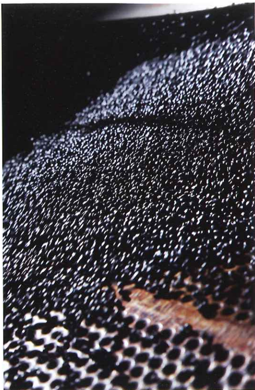
Polypropylen-Compounds aus der Verarbeitung der Batteriegehäuse
